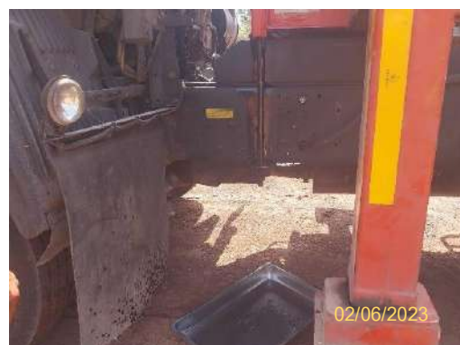
รูปที่ 2-88 วัสดุรองรับคราบน้ำมัน
